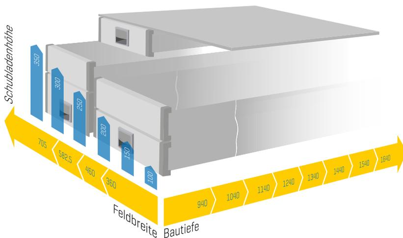
ALUCA dimension2 schafft optimale Ordnung in bedarfsgerechten Schubladen, die sich am Heck oder an der Seite bei offener Schiebetür ausfahren lassen.
