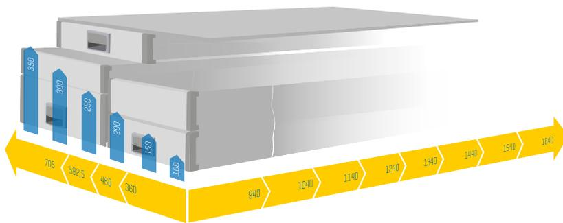
ALUCA dimension2 schafft optimale Ordnung in bedarfsgerechten Schubladen, die sich am Heck oder an der Seite bei offener Schiebetür ausfahren lassen.
