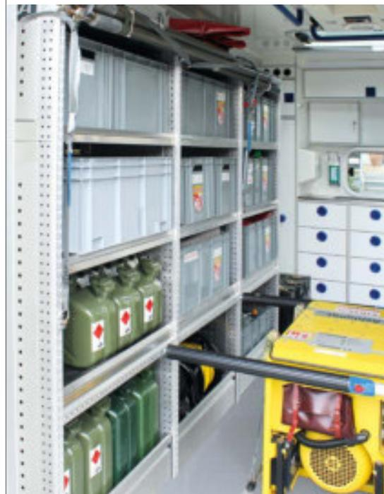
Flexible Transportsicherung des Stromerzeugers mittels quer liegender Spannstäbe.
