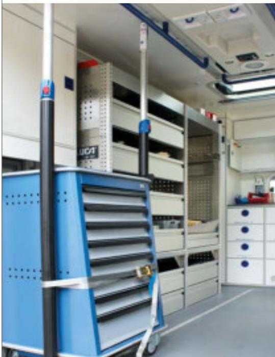
Schnelle Sicherung des Werkstattwagens mittels stehender Spannstäbe.
